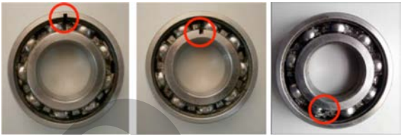
图 2 加工故障后的滚动轴承实物图
